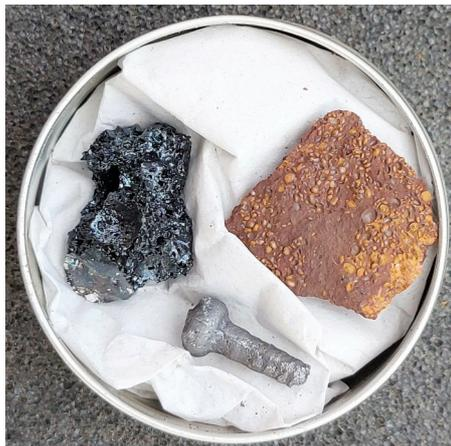
*Oben rechts Herznacher Erz, links Roheisen. Unten die Schraube, der noch das Gewinde fehlt.*
